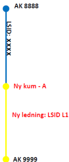
Figur 4-1: Eksempel på identifikasjon av ikke inntegnet kum.
