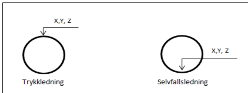
Figur 1. Måling av ledningshøyde.
