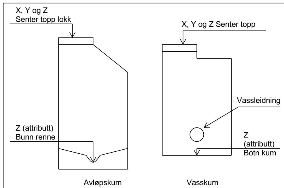
Figur 2. Innmåling av avløpskum og vasskum (snitt).
