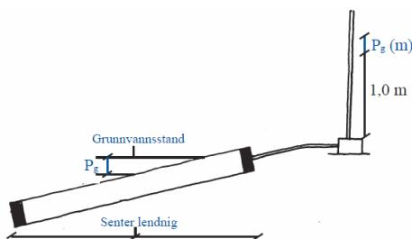
Figur 2. Tethetsprøving ved høy grunnvannsstand.
