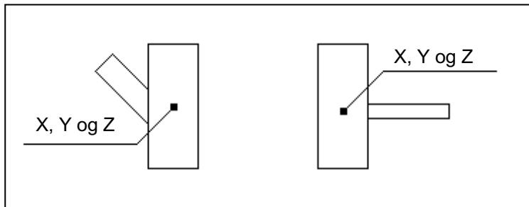
Figur 3. Innmåling av forgreining og anboring (plan).
