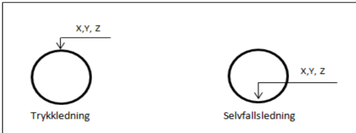
Figur 3 Referansepunkter for innmåling av en trykkledning og en selvfallsledning.
